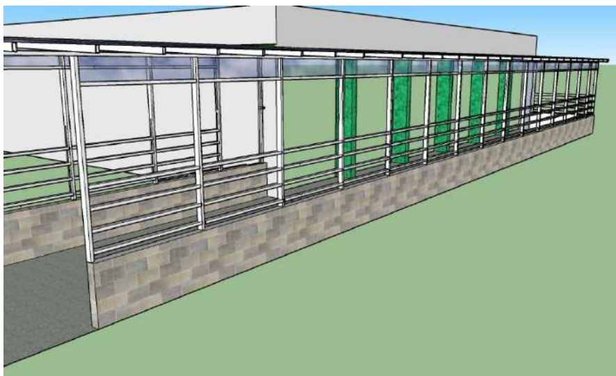
Imagem 4 – Lateral Direita – Cobertura em Vidro Laminado
