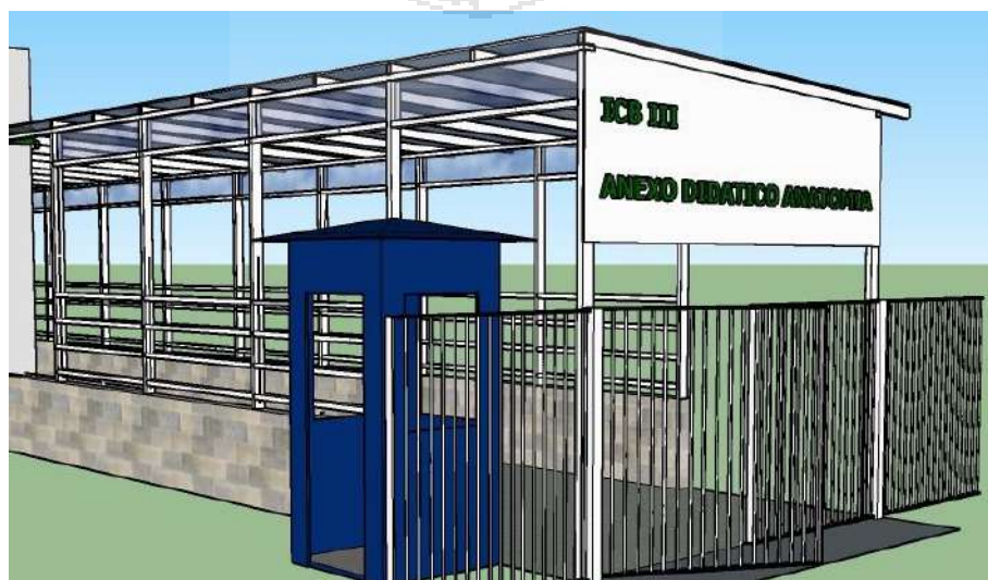
Imagem 3 – Lateral Esquerda – Cobertura em Vidro Laminado
